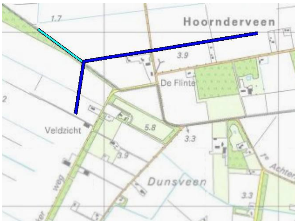
Afbeelding 3 : Ligging van de leiding N-523-52 op een topografische kaart. De ligging van de leiding na verlegging is weergegeven in het donkerblauw; de ligging van de leiding voor verlegging is weergegeven in het lichtblauw.
